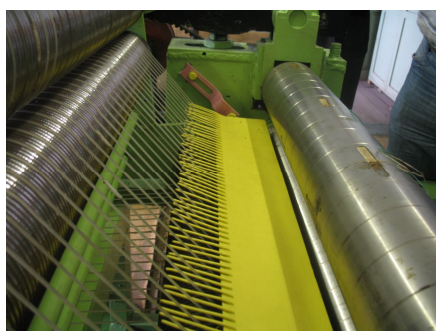
Рис. 2. Экспериментальный стенд машины со средством для направления и плавной подачи кожевенного полуфабриката
