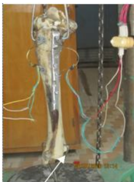
Рис. 1. Места установки датчиков перемещения
